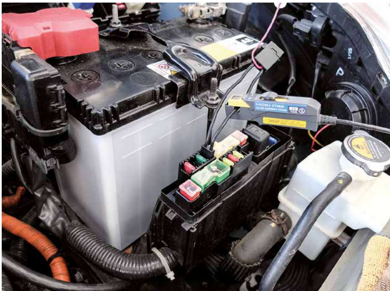
Sensore di corrente AC/DC Hioki a 2A. L'azienda ha sviluppato diverse tipologie di questi dispositivi che si integrano perfettamente con il registratore di dati LR8450.
